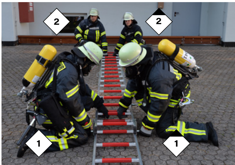
Abb. 41: Verbinden der Multifunktions- leitern
