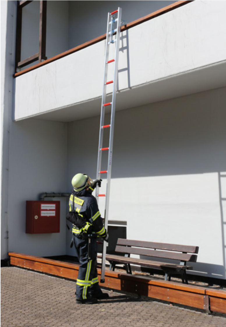
Abb. 27: Einhängen der Hakenleiter
